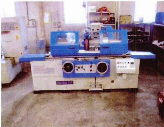
Vista da retificadora cilíndrica universal fabricante Magnus Cut modelo RU-1130
