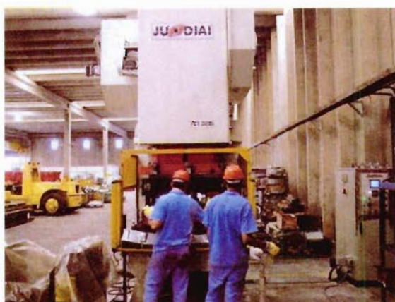
Vista da prensa excêntrica fabricante Prensa Jundiaí modelo TCI-320 F6
