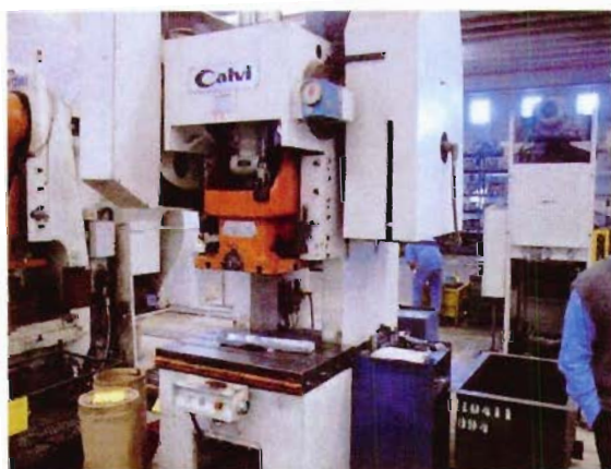
Vista da prensa excêntrica fabricante Calvi excêntrica tipo C nº capacidade 125 ton
