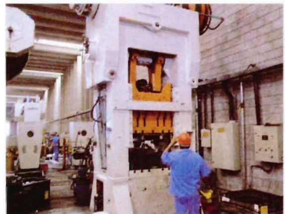
Vista da prensa hidráulica fabricante Gutmann capacidade 250 ton
