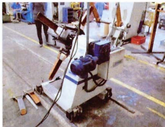
Vista do desbobinador fabricante Tecnopress modelo DVTM200ROT
