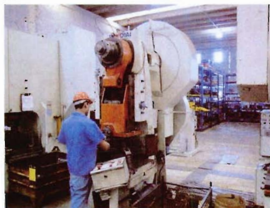
Vista prensa excêntrica fabricante Prensa Jundiaí modelo EL150 F6 excêntrica tipo C
