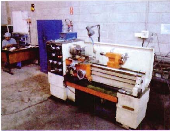
Vista do torno mecânico fabricante Nardini nº série EO KEK 4402 Mascote MS 205
