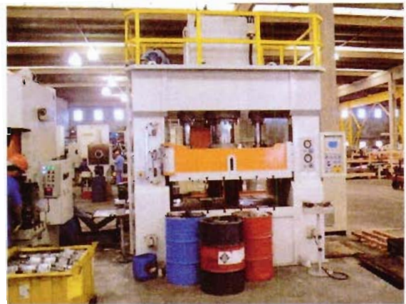
Vista da prensa hidráulica fabricante Rio Negro modelo PDE-63 tipo hidráulica
