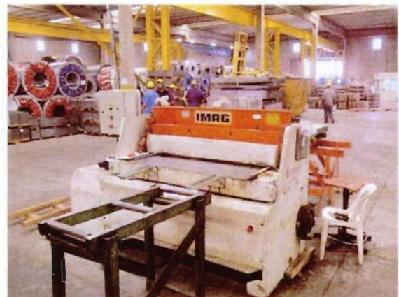
Vista da guilhotina de corte transversal marca Imag modelo TI-XIII-ME nº 1856
