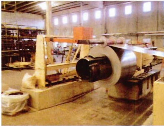
Detalhe do enrolador - máquina 02 de corte longitudinal
