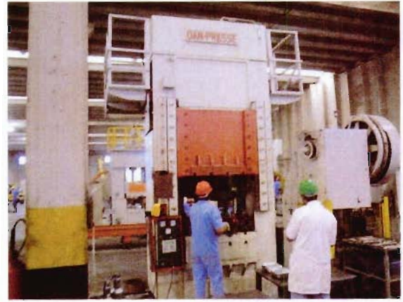
Vista da prensa hidráulica fabricante Dan-Pressse capacidade 200 ton
