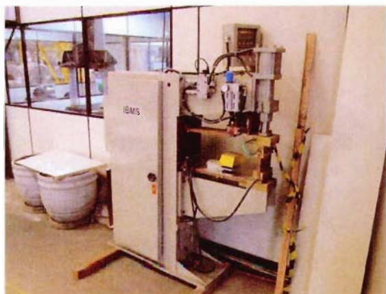
Vista da máquina de solda em projeção fabricante IBMS n° série 2593
