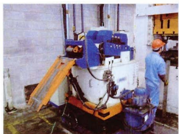
Vista do endireitador fabricante Tecnopress modelo Falte M-300
