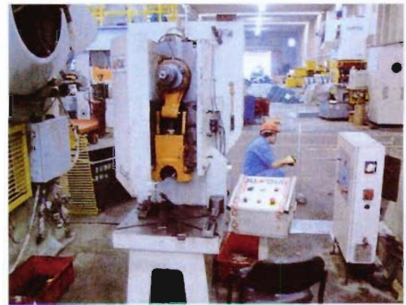
Vista da prensa excêntrica fabricante Prensa Jundiaí modelo ELC 45 F2
