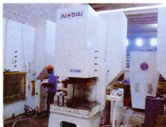
Vista da prensa excêntrica fabricante Prensa Jundiaí modelo ELC160 F6 excêntrica tipo C
