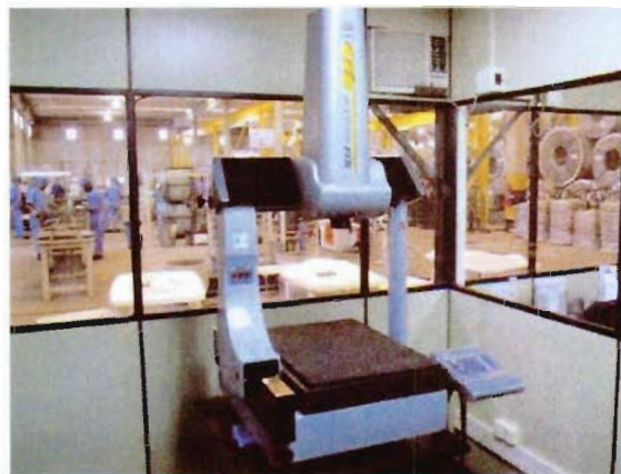
Vista da máquina de medição tridimensional fabricante Tesa n° série 08020021
