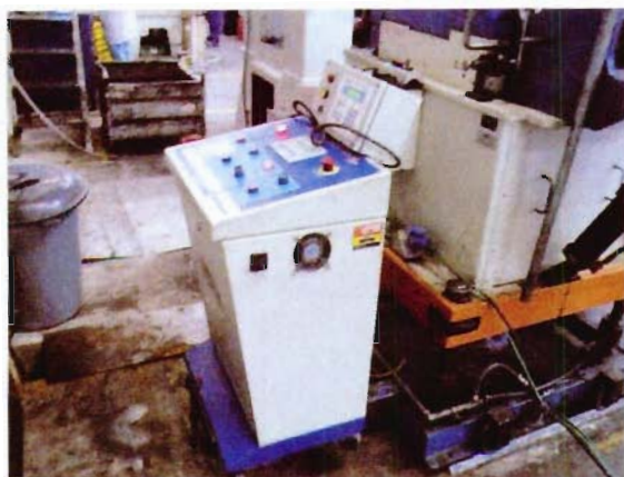
Vista do servo alimentador fabricante Tecnopress modelo Ultra
