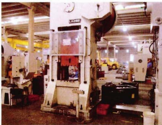
Vista da prensa excêntrica fabricante Prensa Jundiaí modelo LA200 4C F5
