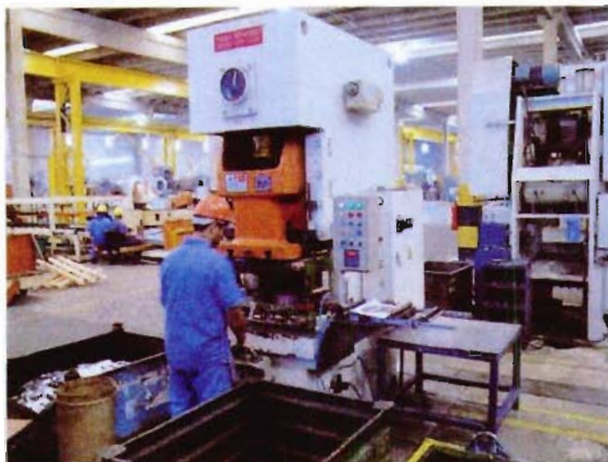
Vista da prensa excêntrica fabricante JIN modelo H21-80
