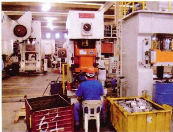
Vista darensa excêntrica fabricante JIN modelo JH21-80 excêntrica tipo C
