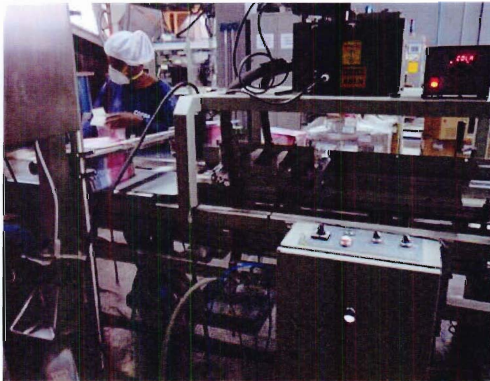
Foto: Sistema de Fechamento de Caixa e Aplicação de Hot Melt.
