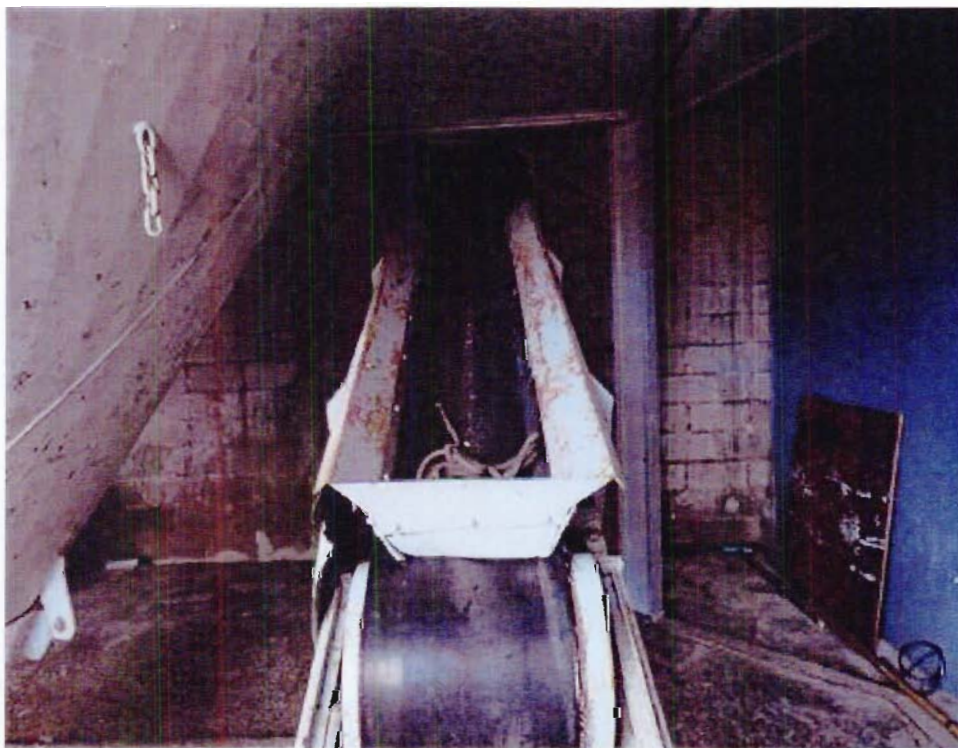
Foto: Esteira Transportadora tipo Correia – 5,0 mt.
